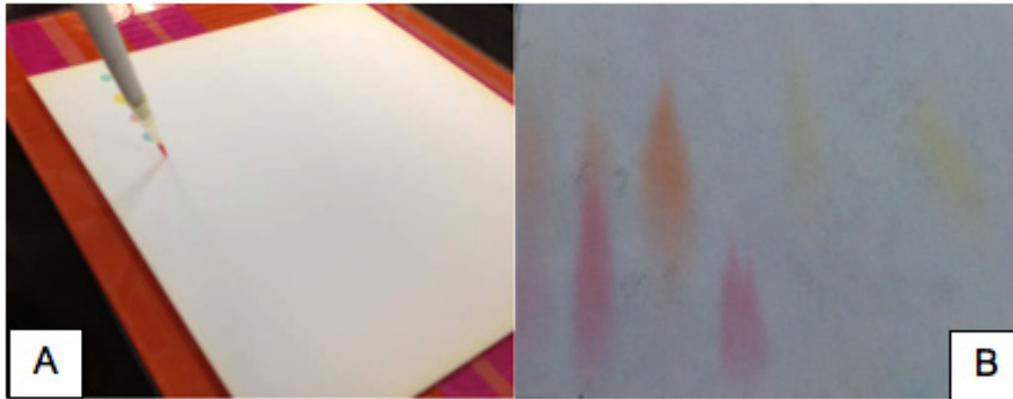
Figura 3.3. Cromatografía en capa fina. A) colocación de los colorantes en el rectángulo de papel filtro.
