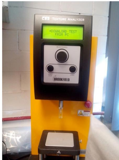
Figura V.2 Texturómetro Brookfield
