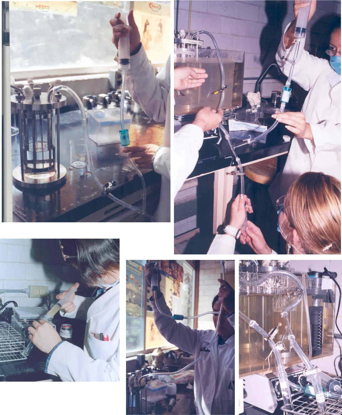
Figura 12. Fotografías del arreglo de los fermentadores para muestreo e incubación en el sistema anaerobio (fermentación alcohólica).
