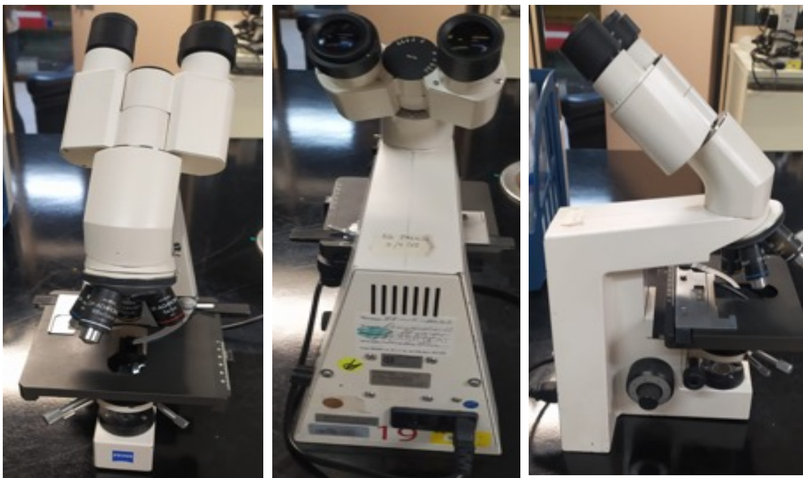
Figura 3. Microscopio óptico (binocular) de la marca Carl Zeiss, modelo NSZ-405. Vista frontal (izquierda), vista posterior (centro) y lateral (derecha). Los oculares se sitúan en la parte posterior y la muestra se pone sobre la platina, que se encuentra en la parte frontal. Laboratorios Divisionales de Docencia, Ciencias Biológicas y de la Salud (CBS). Edificio AS, Unidad Iztapalapa, Universidad Autónoma Metropolitana (UAM), Ciudad de México.
