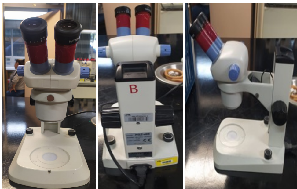
Figura 1. Microscopio estereoscópico (binocular) de la marca Novel, modelo NSZ-405. Vista frontal (izquierda), vista posterior (centro) y lateral (derecha). En las imágenes posterior y lateral se puede observar una estructura negra al final de la columna o brazo, que es utilizada para tomar el microscopio. Laboratorios Divisionales de Docencia, Ciencias Biológicas y de la Salud (CBS). Edificio AS, Unidad Iztapalapa, Universidad Autónoma Metropolitana (UAM), Ciudad de México.
