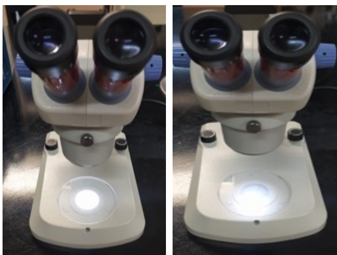
Figura 2. Iluminaciones de los microscopios estereoscópicos Novel, Modelo NSZ-405. Iluminación (lámpara) inferior encendida (ON; izquierda) y lámpara superior encendida (ON; derecha), las cuales se controlan de manera independiente con los botones que se encuentran en la parte inferior trasera de la base. Laboratorios Divisionales de Docencia, Ciencias Biológicas y de la Salud (CBS). Edificio AS, Unidad Iztapalapa, Universidad Autónoma Metropolitana (UAM), Ciudad de México.
